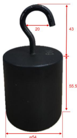
图 1 单钩砝码照片及尺寸
